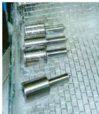
«До» и «после» ультразвуковой очистки ремонтируемых деталей
