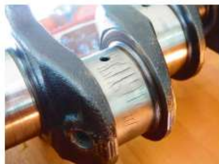
Как важно вовремя обнаружить скрытые дефекты в ответственных деталях (слева – коленчатый вал двигателя), чтобы не допустить в последующем их разрушения (справа – результат бесконтрольного ремонта)
